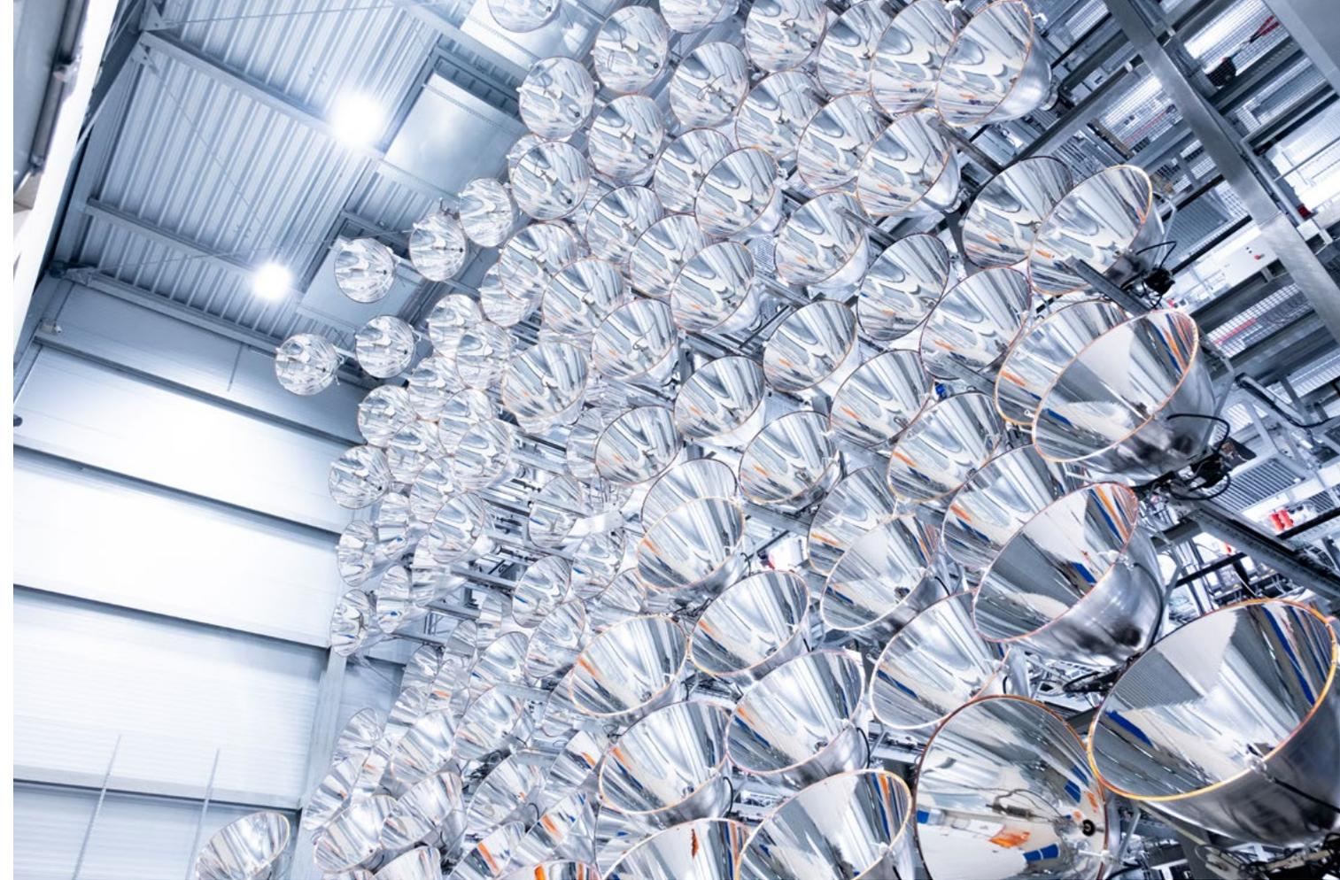
**Imposant.** Die 149 Lampen sind auf einem 14 x 16 Meter Gerüst wabenförmig angeordnet.
